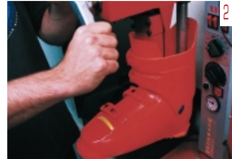
De vegades, cal deformar les carcasses de les botes per adaptar-les a casos extrems.
