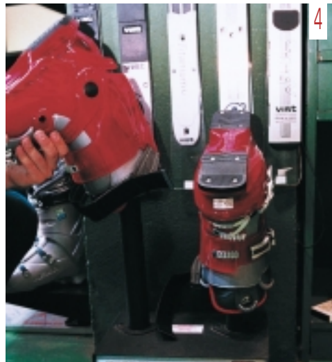
Aquesta màquina serveix per adaptar les botes al peu del client en el moment de la compra.
